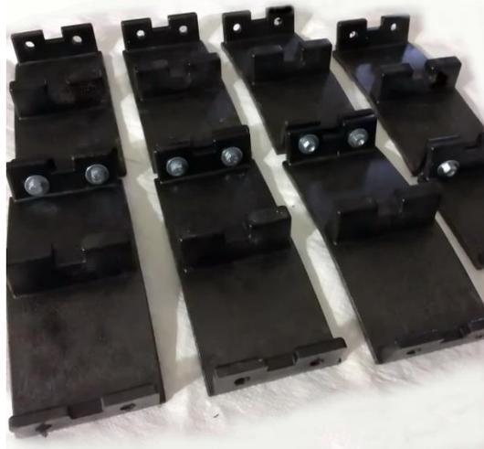
**Предназначение.** Спейсеры предназначены для диэлектрической изоляции между трубами и обеспечения легкой вставляемости рабочей трубы со спейсерами в трубу-кожух.
