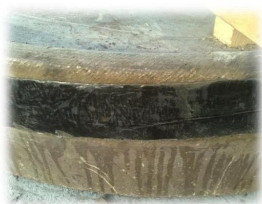
Рис.2 Подмоточный слой сырой резины на футляре.
